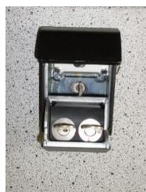
Grundsätzlich ist das Wachpostengehäuse mit der Ausführung "Gehäuse-Kontakt-Geschlossen" geliefert. Die Ausführung "Schlüsselkontrolle" sichert dem Wachpostengehäuse die Präsenz und Identität von jedem abgelegten Schlüssel.
