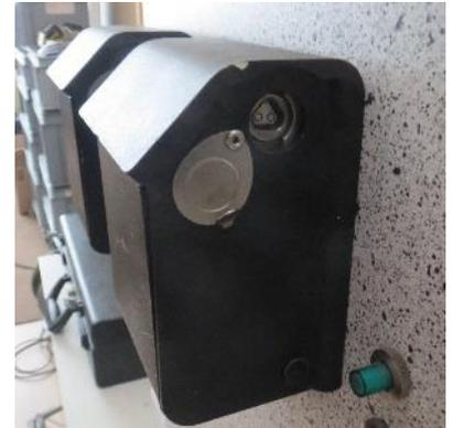
Das Gehäuse wird mit einen Cyberzylinder, CL-PH30, Europrofil, 30 mm zum Lauf, geöffnet oder verriegelt.
