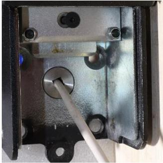
In der Basisausführung ist das Gehäuse ohne Schliesspositionskontakt geliefert. Option bei der Bestellung angeben.
